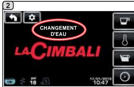
Le message « *CHANGEMENT D'EAU* » apparaîtra ; l'eau de la chaudière sera évacuée par la buse d'eau chaude (60 - 70 % environ de la capacité totale).
