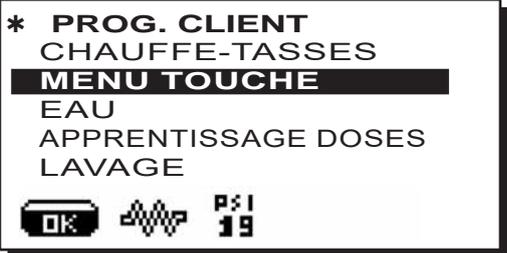
Placer le curseur (ligne foncée) sur la ligne désirée en utilisant les touches ▲ et ▼, puis appuyer sur la touche ►.
