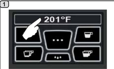
1 Appuyer sur l'écran du chauffe-eau au niveau de l'indication de la température.
