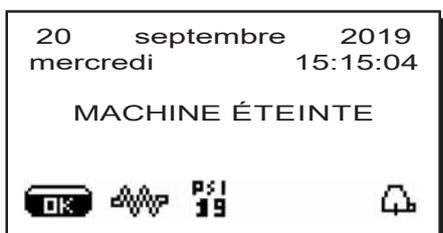
**N.B. :** quand la machine fonctionne avec allumage/ extinction automatique, ne pas utiliser l'interrupteur lumineux général pour éteindre la machine, car dans cette condition, l'allumage automatique n'est pas possible.
