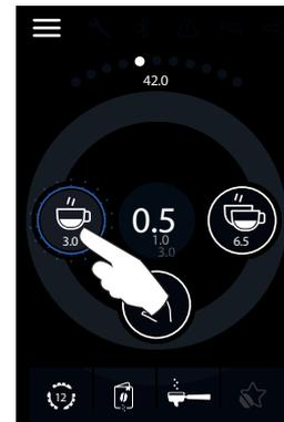
Sélectionner la dose choisie en appuyant sur l'icône sur l'écran tactile. Le moulin-doseur se met en marche pendant le temps de dosage réglé et le café moulu descend par le conduit (10). La mouture s'arrête automatiquement. En cas de « dose simple » ou de « dose double » : le chiffre qui apparaît au centre de l'écran indique le « compte à rebours » de l'opération. En cas de débit continu : le comptage commence à partir de 0 (zéro) et augmente.
